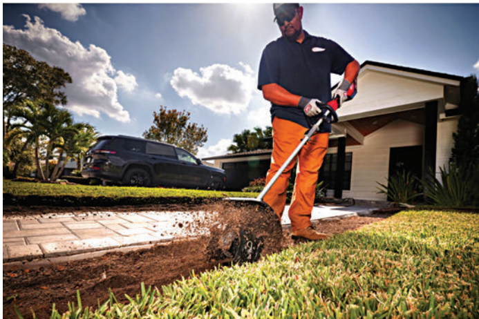
Культиватор, ширина насадки 220 мм
