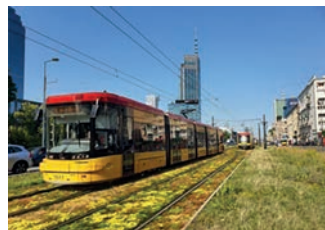
12 Озеленення трамвайних колій у Варшаві. Зі статті «Zielone tory – teraz czas na centrum Warszawy» [https://tw.waw.pl/zielone-tory-w-centrum-warszawy/]
